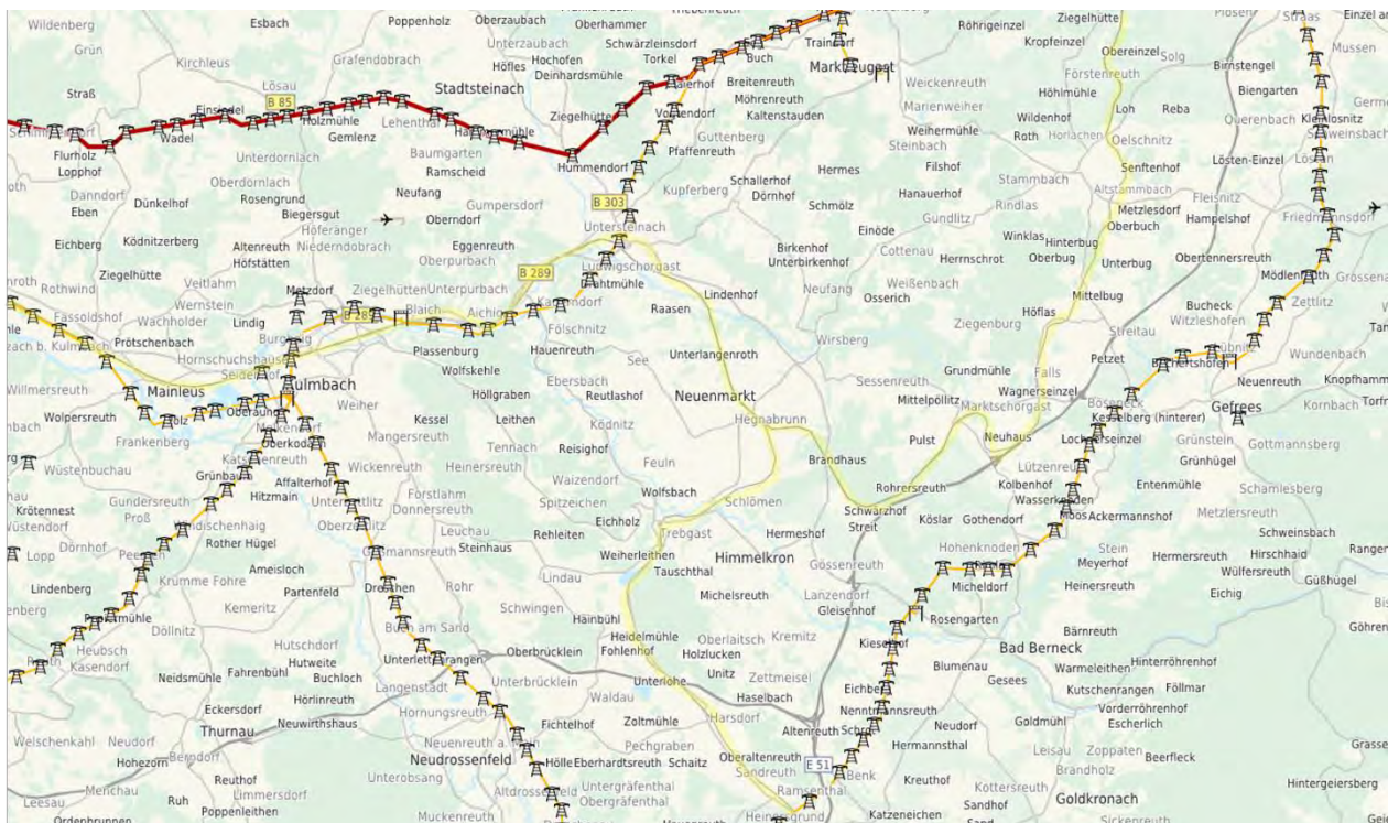
Abbildung 11-1: 50-Hz-Hochspannungsleitungen im Betrachtungsraum (Quelle: https://www.flosm.de/ ); Ergänzt mit den relevanten Bahngleisen zwischen Kulmbach via Neuenmarkt-Wirsberg in Richtung Oberkotzau sowie in Richtung Bayreuth (gelb).
