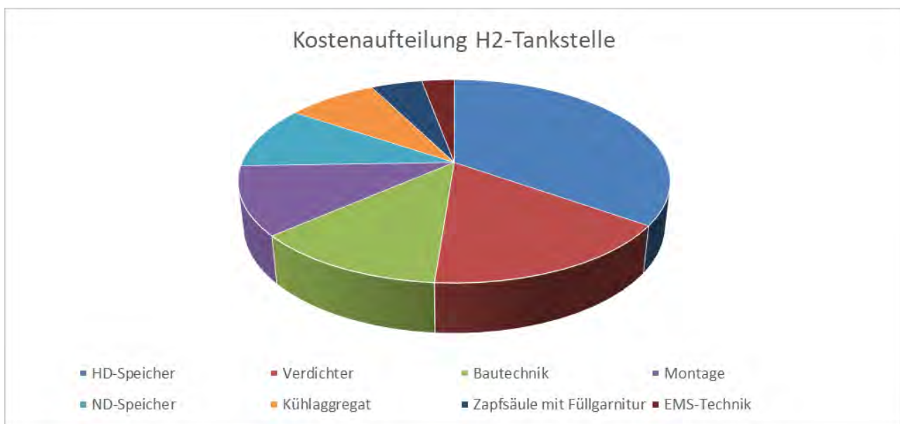
Abbildung 20-1: Darstellung Kostenbestandteile einer H 2 -Tankstelle
